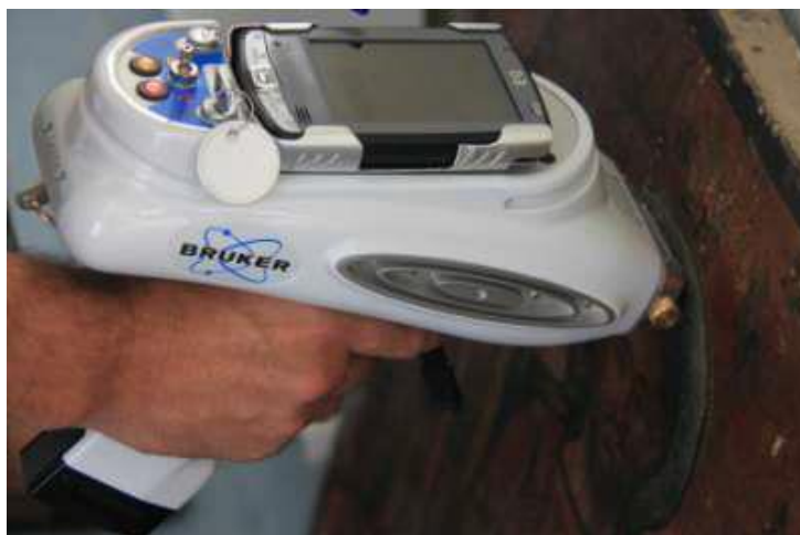
Εικόνα 5. Ανίχνευση χημικών στοιχείων σε βυζαντινή εικόνα, καθώς και στοιχειακή ποιοτική και ποσοτική ανάλυση με τη χρήση φορητού οργάνου XRF
