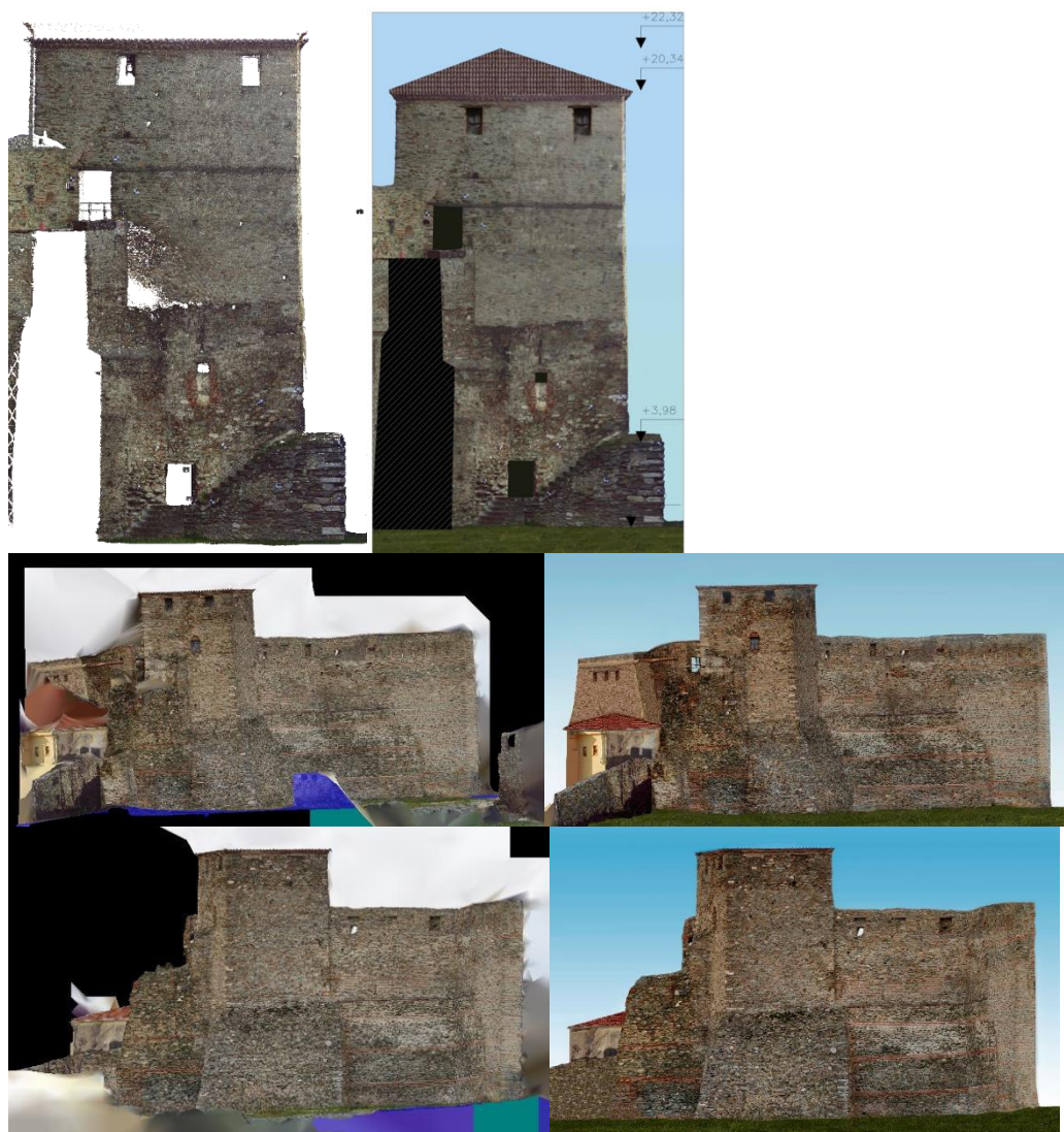
Εικόνα 9: Ψηφιακή αποτύπωση Πύργου μέσω 3D laser scanning. Ορθοφωτογραφίες ΝΔ, ΒΔ και Β όψης του Πύργου, πριν και μετά την επεξεργασία στο Photoshop
