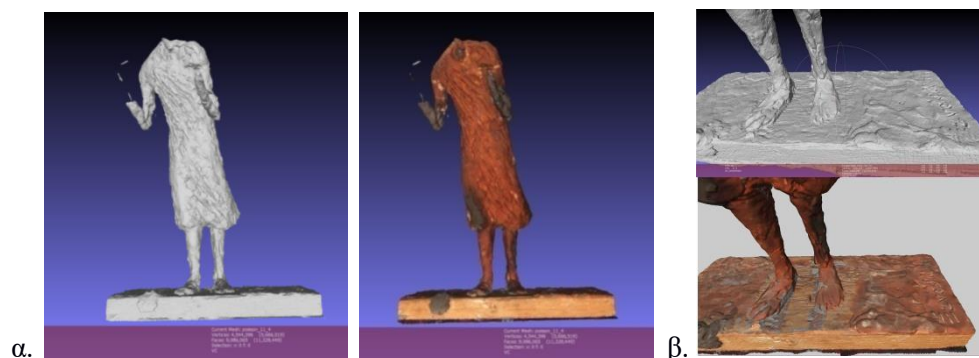
Εικ. 4. Το αποτέλεσμα της τρισδιάστατης σάρωσης του σώματος του κέρινου προπλάσματος (α) και λεπτομέρεια της βάσης (β), χωρίς και με χρωματική πληροφορία στο περιβάλλον του Meshlab.
