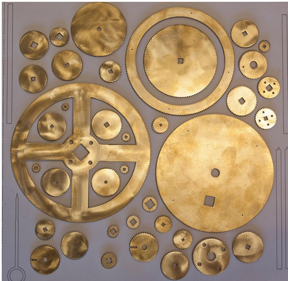
Εικόνα 8: Κατασκευασμένα ακριβή αντίγραφα όλων των γραναζιών του Μηχανισμού
