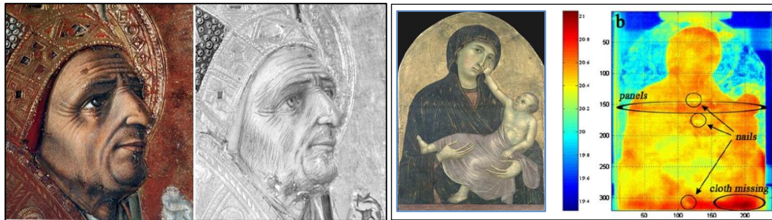
Εικόνα 17. (α) Αποκάλυψη πληροφοριών, που δεν φαίνονται στο ορατό φάσμα, με τη χρήση υπέρυθρου φιλμ, (β) Παθητική θερμογραφία σε ξύλινη αγιογραφία και εντοπισμός προβληματικών περιοχών
